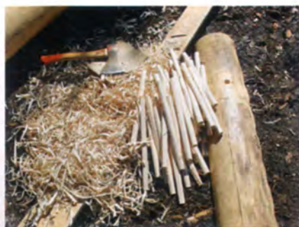
Стандартная ошибка: изготовление нагелей из хвойных, а не из более твёрдых лиственных пород дерева.
