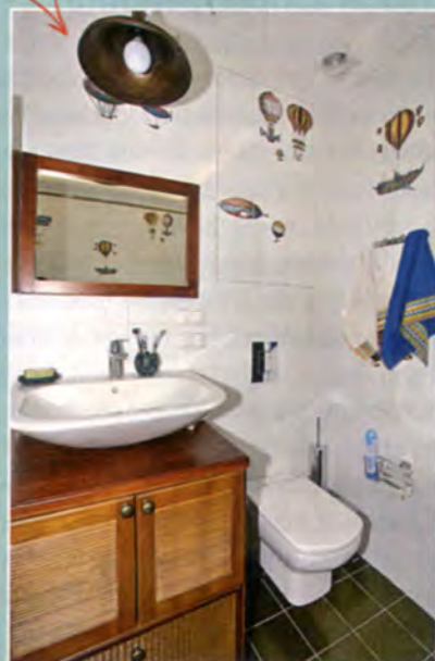
Подвесной унитаз — хороший выбор, если нужны дополнительные места для хранения. Над стойкой унитаза получился вместительный шкаф. Люк-невидимка оформлен той же плиткой, что и стены, и действительно почти незаметен. А ещё под навесным унитазом удобнее мыть пол.
